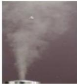
微細粒子は、空間中で揮発現象をともなってさらに微細化が進み、床面に落下しながら、やがて視認できない粒径になる。この時、次亜塩素酸は揮発して室内に拡散する（＝気体状次亜塩素酸）。
